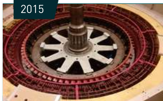
HPP Lajanuri, Georgia 49000 kVA 11000 V, 250 rpm V1
