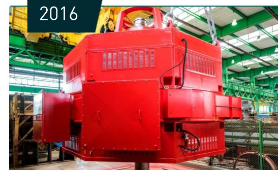
HPP SanBartolo, Panama 2 x 12000 kVA, 11000 V, 300 rpm ONv 3450x670/24 Kaplan
