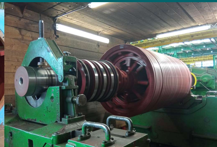
Type FTA 800Ks6 5400 kW 6300 V 50 Hz 6 Pole
